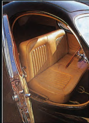
Die Selbstmördertüren öffnen nach vorne
