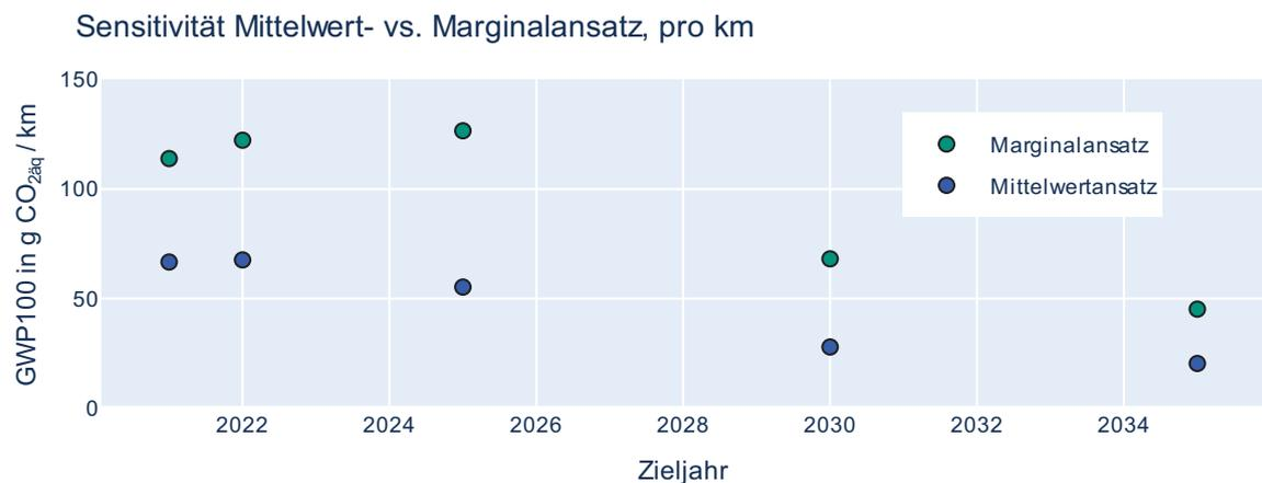
**Bild 19.** THG-Emissionen der Nutzung eines BEV bei 16,8 kWh/100 km Fahrenergiebedarf nach WLTP nach Marginalansatz und Mittelwertansatz, Szenario KNDE45
