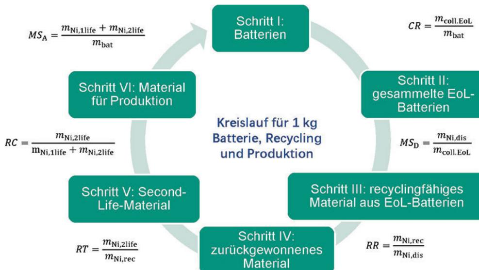
**Bild 8. Beispielhafter Stoffkreislauf zum Batterierecycling für Nickel (Größen nach Tabelle A4)**
